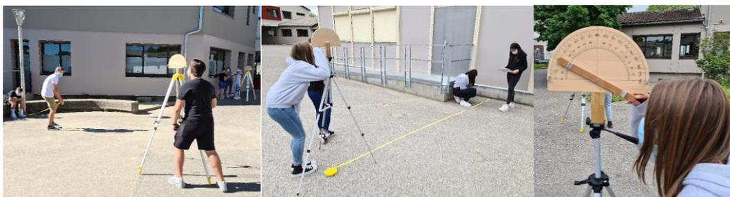
Les mesures au graphomètre sur le terrain
