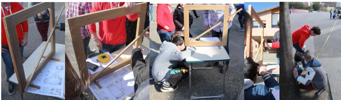
Étapes des mesures au carré géométrique sur le terrain : visée avec le carré puis mesures directes de la distance entre le carré et le pied de la hauteur inaccessible au décimètre
