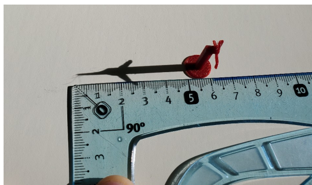
Figure 15: Mesure de la longueur de l'ombre de l'éolienne à l'échelle 1/2400 .
