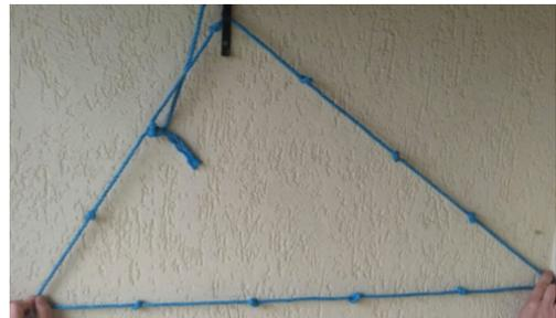
Figure 12 : Usage d'une corde à 13 nœuds.
