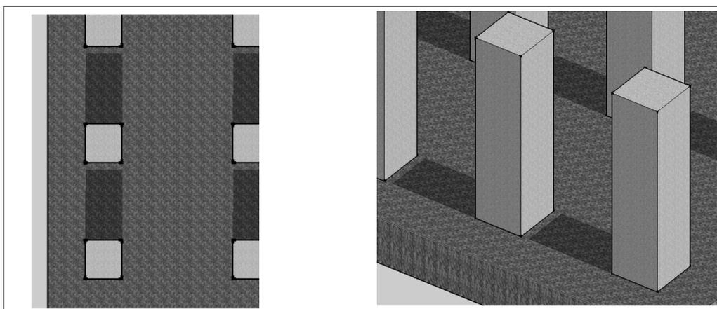
Fig. 11 – Extraits de la modélisation en dimension trois du second projet de l'Alignement avec des colonnes de 3,6 m de hauteur à midi solaire, réalisée avec le logiciel SketchUp – vue de dessus et zooms
