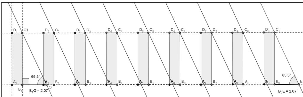
Fig. 9 – Modélisation de l'Alignement du XXIème siècle vue de côté à la hauteur du soleil maximum de  $65,3^\circ$  réalisée avec le logiciel de géométrie dynamique GeoGebra
