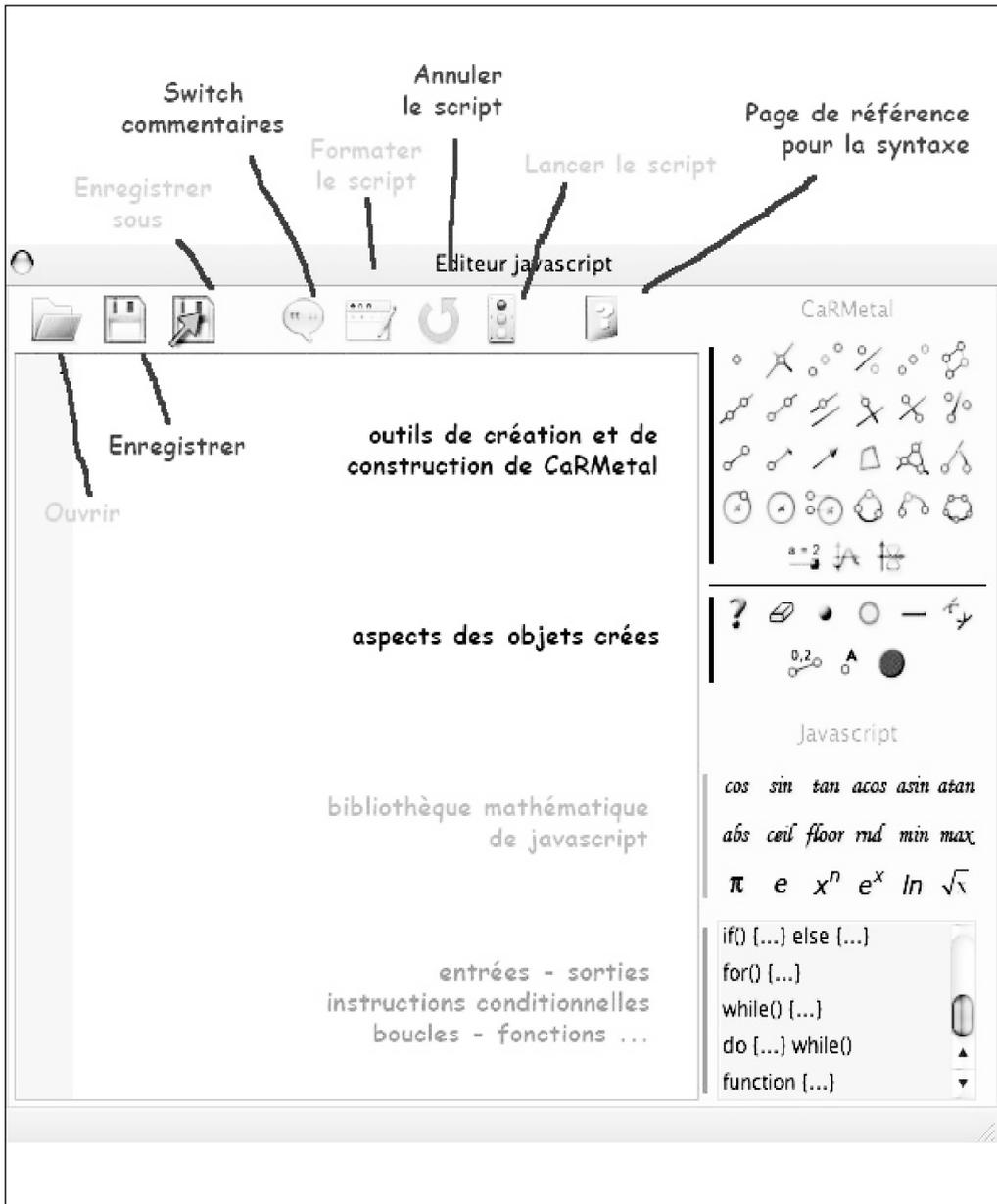
On remarquera les deux parties de la palette d'outils : une partie orientée géométrie, et une partie orientée programmation en JS.
