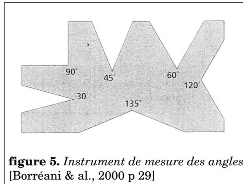
Dans l'exemple ci-dessus, l'instrument que nous présentons ne comporte pas de graduation et fait appel à des gabarits d'angle multiples. Il rappelle les polygones utilisés dans différentes activités décrites précédemment (cf. l'angle de secteur).
