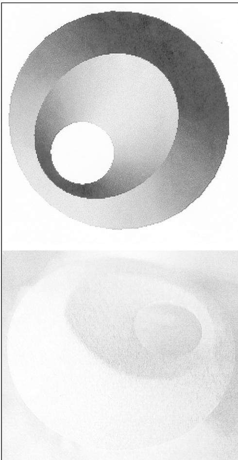
L'**ellipse** est obtenue avec une plaque circulaire percée d'un disque excentré.
