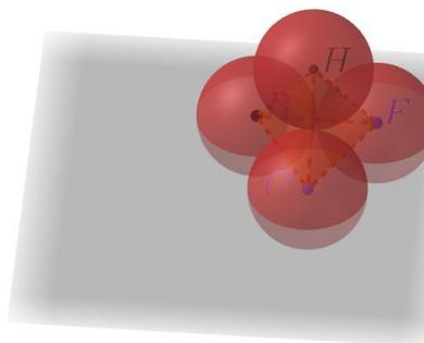
FIGURE 4 – Empilement compact en trois dimensions : les centres de quatre balles adjacentes forment un tétraèdre régulier.
