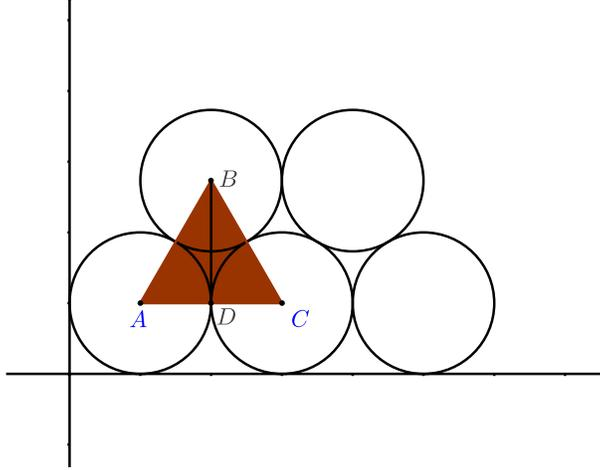
FIGURE 2 – Empilement selon un réseau hexagonal en deux dimensions.
