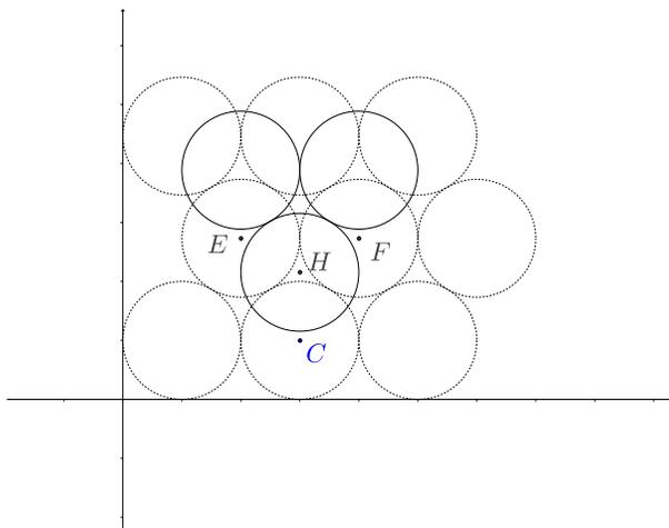
FIGURE 3 – Empilement compact en trois dimensions : la couche basse est en pointillés.
