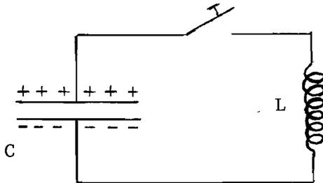
Considérons un circuit électrique comprenant un condensateur de capacité  $C$  portant une charge  $q$ , un interrupteur et une bobine de self inductable  $L$ .
