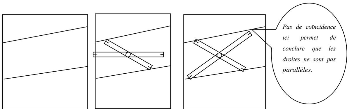
Le lecteur n'aura aucun mal à imaginer la manipulation de l'outil qui permet de construire la parallèle à une droite donnée passant par un point donné. Une taille convenablement choisie de l'outil ou la fabrication d'un jeu de deux ou trois de ces « croix » de tailles différentes permet à peu près toutes les vérifications ou constructions qui se présenteraient dans le cadre, somme toute assez réduit, de la feuille de papier.
