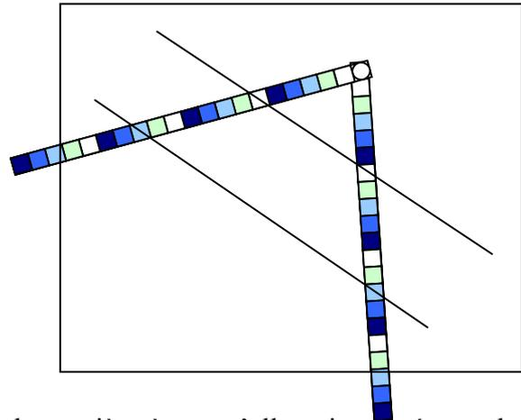
Technique : On dispose la première réglette de manière à ce qu'elle soit coupée par les droites tracées suivant deux graduations. On fait pivoter la seconde jusqu'à ce que l'une des droites la coupe suivant la même graduation que l'autre réglette. On observe alors sur quelle graduation cette deuxième réglette est coupée par la seconde droite.
