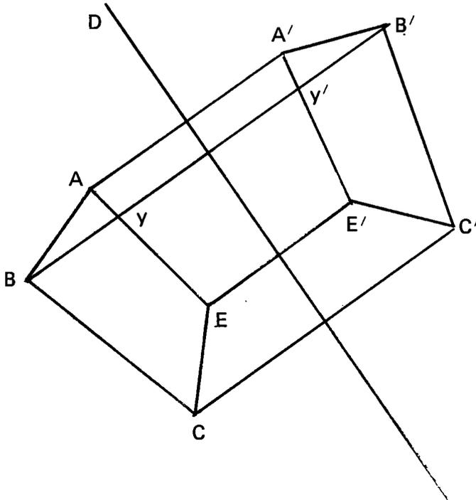
2) J'ai tracé, avec l'équerre, les droites de liaisons perpendiculaires à l'axe de symétrie D en passant par A, B, C, E. En pointant sur l'axe D j'ai pris l'écartement D-A ; même chose pour B, C, E, je l'ai reporté de l'autre côté de l'axe en faisant la même chose pour les 3 autres points. J'ai lié les 4 points pour former la figure.
