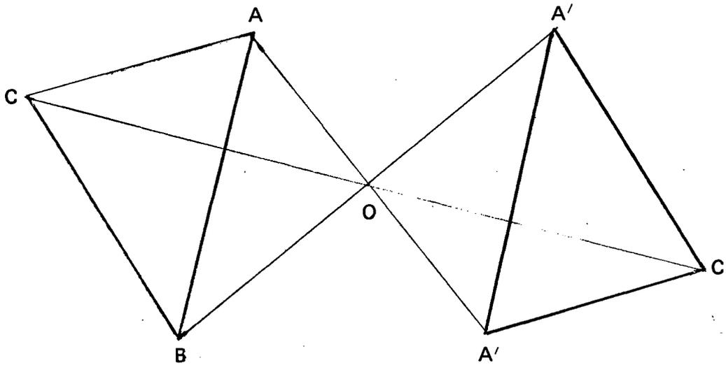
2) J'ai mis la pointe de mon compas sur le point O, j'ai pris la distance de A à O et j'ai tracé la droite partant de A, passant par O et coupant le cercle de A. J'ai pris l'intersection de la droite et du cercle et j'ai trouvé le point A'. J'ai fait ainsi pour les autres points.
