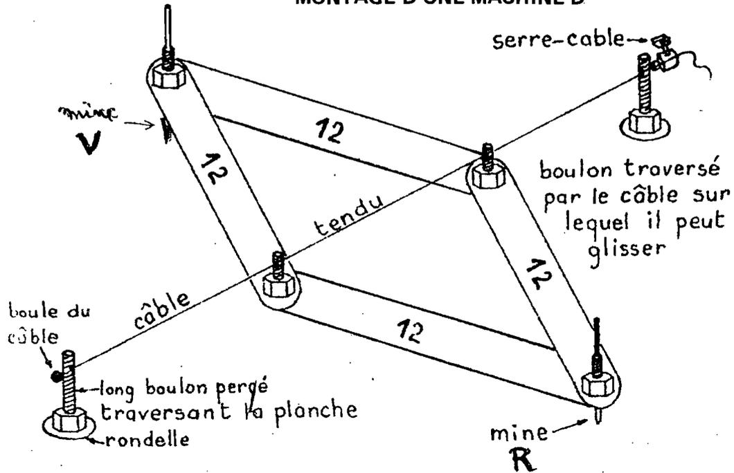
Dans une conception ultérieure de la machine D, nous remplaçons avantageusement le câble par une tige rigide, type tringle à rideau (cf. photo et annexe).
