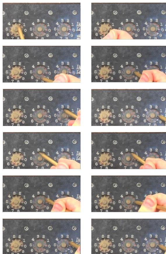
**Figure 3 :** Étapes du calcul de  $283+31$  avec la LC, deux photos pour l'inscription de chaque chiffre, quatre pour bien voir la transmission de la retenue lorsque l'on inscrit 30.
