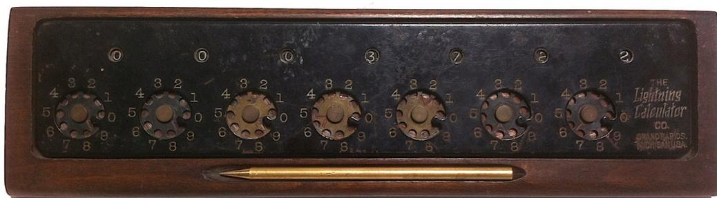
**Figure 1 :** Additionneuse à roues Lightning Calculator (brevet 1926, dimensions réelles : 34 cm × 8 cm × 5 cm).
