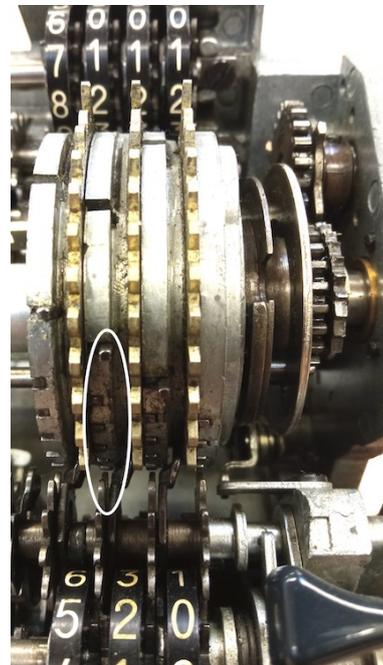
**Figure 15** : Détail de l'entraîneur d'Odhner sur une machine construite pour l'apprentissage. On voit la dent cylindrique à section carrée qui va engrener le totalisateur.
