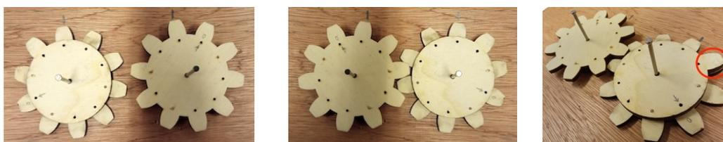
**Figure 6** : Représentation des nombres avec des roues à 10 dents, 1 et 3 à gauche mais 13 au milieu et à droite grâce à l'engrenage de la roue à une dent du 3 avec celle du 1 (dent cerclée à droite).
