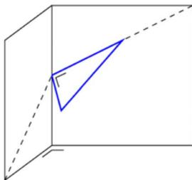
Figure 13 – En plaçant une équerre à l'intersection de deux plans perpendiculaires, si un côté de l'équerre est incliné et collé à un des plans, l'autre côté ne peut coller à l'autre plan.
