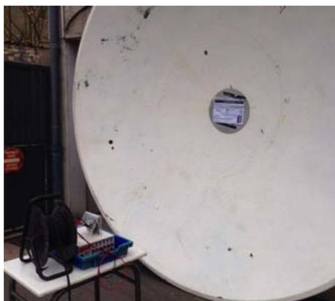
On a remarqué que le niveau sonore était maximal à une distance de 130 cm par rapport au sommet du paraboloïde, ce qui correspondrait à la position du foyer.
