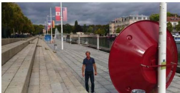
Nous avons choisi des paraboles, car leur forme permet de concentrer l'ensemble des ondes incidentes en les faisant converger en un point : le foyer  $F$  (à condition qu'elles arrivent parallèles à l'axe de symétrie de la parabole, ce qui était le cas puisque le canon était suffisamment éloigné des récepteurs).
