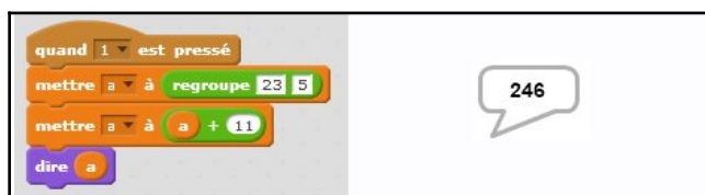
Figure 6 : Script Scratch montrant l'absence de typage des valeurs utilisées.
