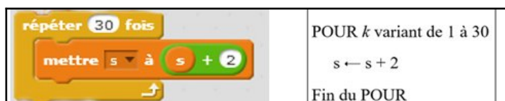
Figure 14 : Traduction en langage algorithmique d’un script Scratch contenant une boucle bornée.
