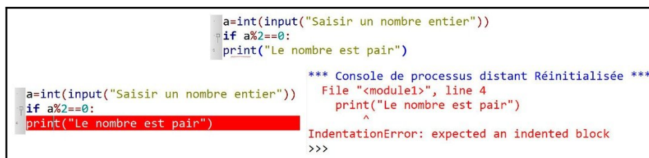
Figure 11 : L'indentation : une source d'erreur.
