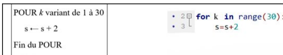
Figure 15 : Différences entre le langage algorithmique et Python : deux lignes au lieu de trois et indentation nécessaire.
