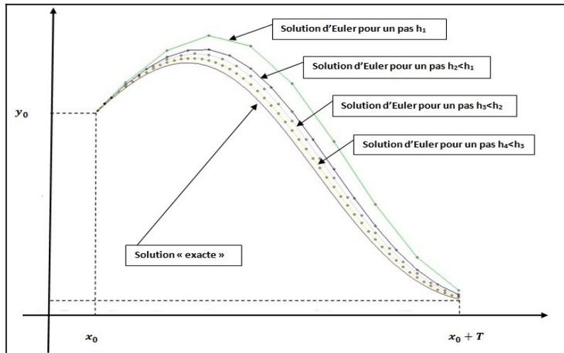
**Figure 2 :** L'usage de Maple dans l'approximation des solutions d'une ED par la méthode d'Euler.
